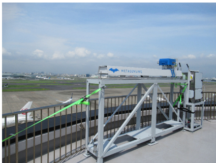
図 7 羽田空港に設置した GB-SAR Fig.7 GB-SAR system installed at Haneda airport.
