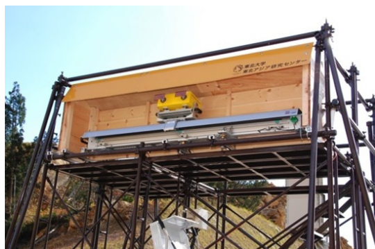
図 1 宮城県・荒砥沢に設置した GB-SAR システム Fig. 1 GB-SAR system installed at Arato-zawa, Miyagi.
