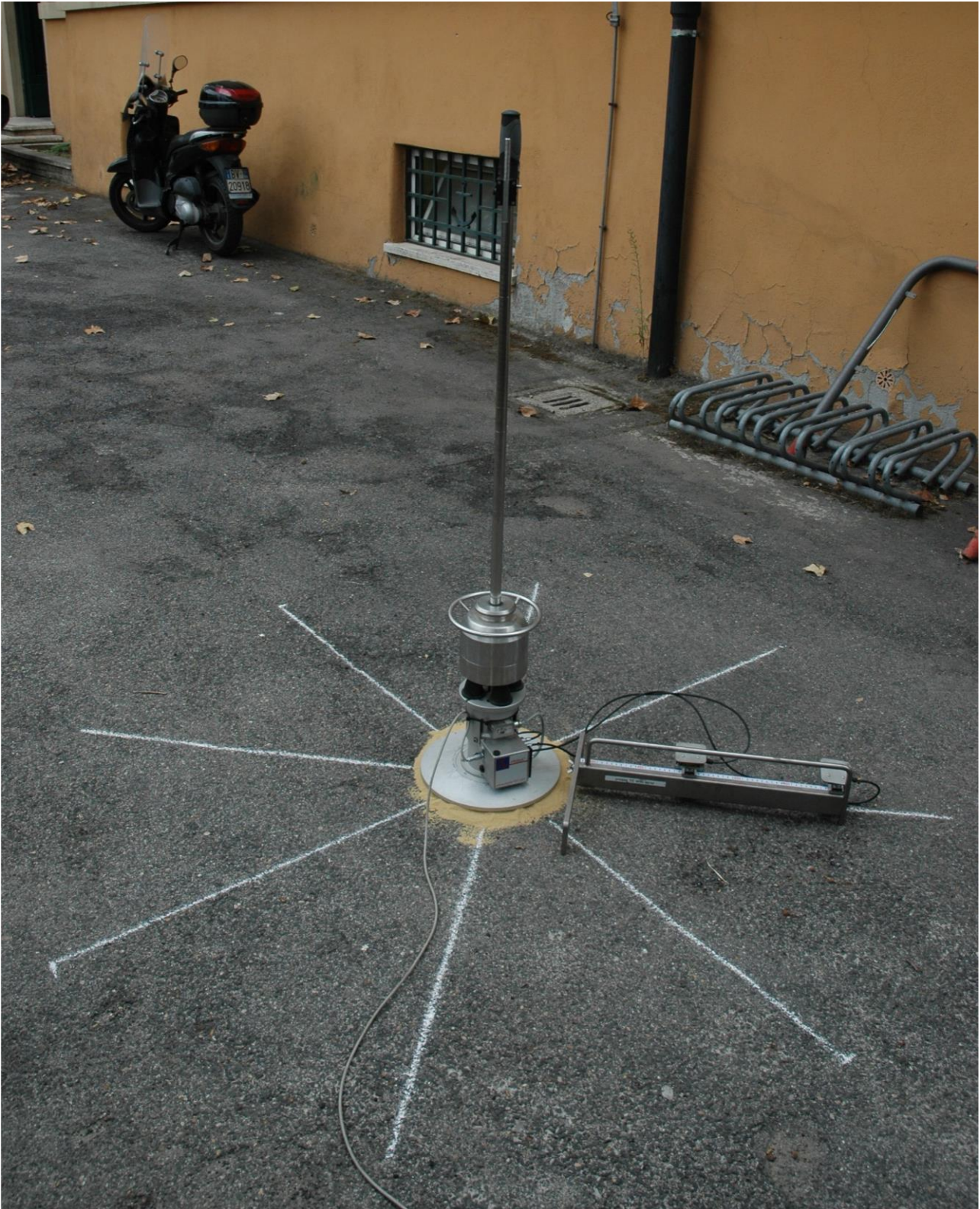
Figura 1: Misura delle caratteristiche meccaniche tramite Light Falling Weight Deflectometer.
