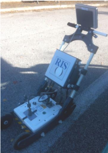
Fig. 3 – Il georadar ad antenne accoppiate a terra RIS 99-MF, prodotto da IDS Ingegneria dei Sistemi SpA.
